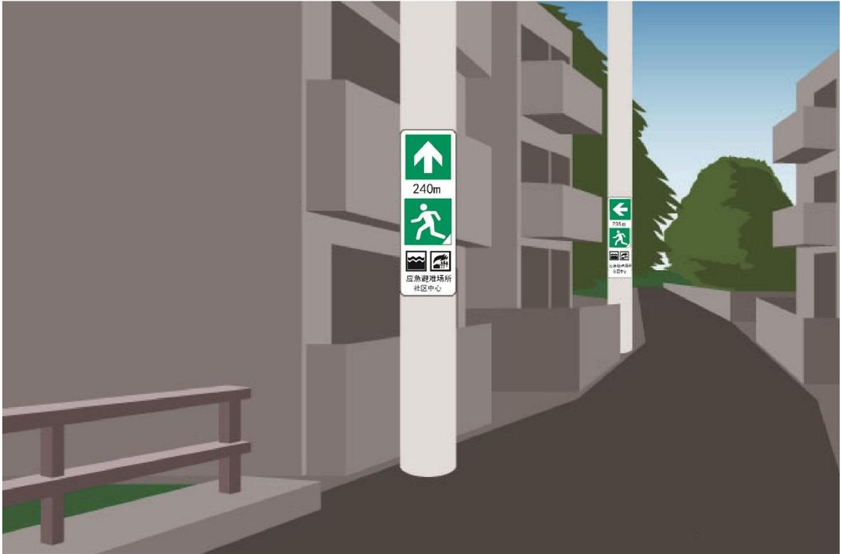
图C.2 建筑物外疏散路线导向标志设置示意
