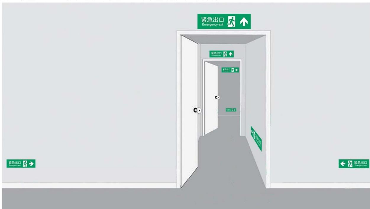
图B.1 紧急出口处的疏散路线导向标志设置的示意
