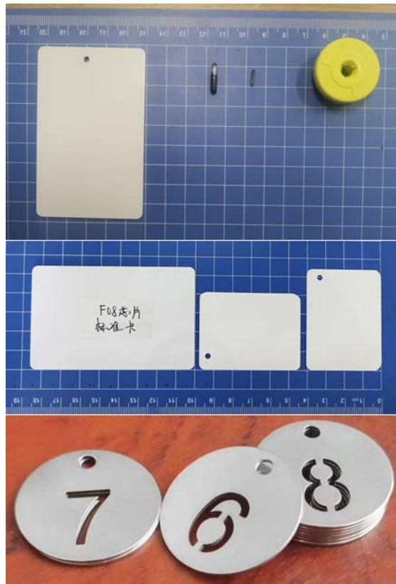
图 2 待筛选标记物（从上到下：低频 RFID，高频 RFID，普通不锈钢标签）
