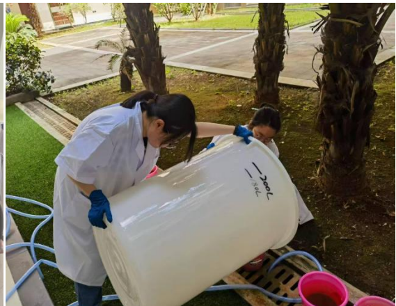
图 2-4. 福建省辐射环境监督站实验人员在进 行海水中钷的前处理实验
