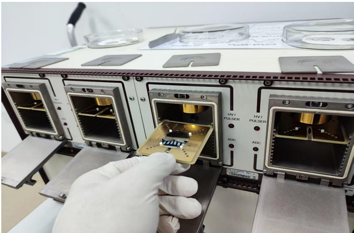
图 2-7. 上海市辐射环境安全技术中心实验人员将制备好的含钷电镀源放入 \alpha 能谱仪中进行测量
