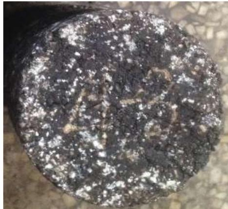
图12 沥青混合料试件表面的盐蚀现象（白色斑点）
